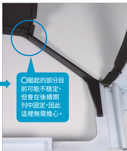
將前柱飾條(L) 82-B 的兩個螺絲孔突起部分對準 82-A 內側的左側前柱螺絲孔凹槽，並將其嵌入固定。
