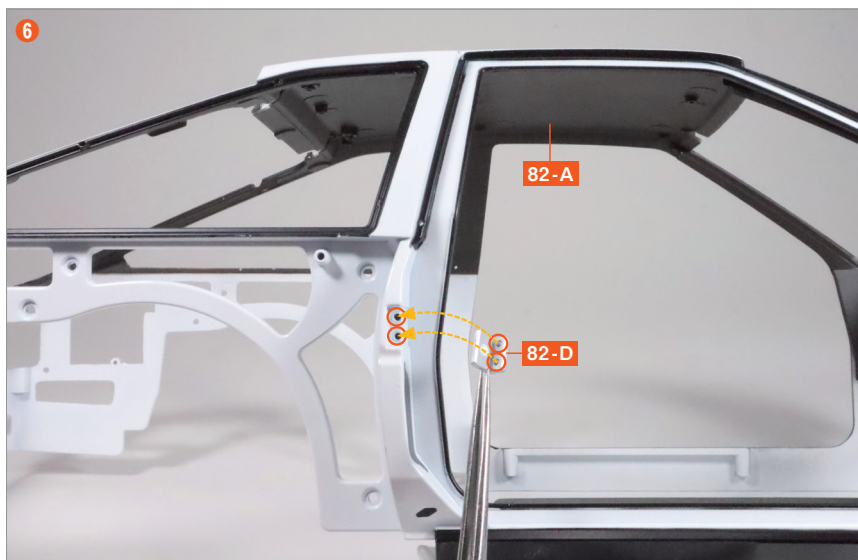
拿起一個門鎖插銷 82-D，對準 82-A 外側的右側中央附近螺絲孔，並使用 AM 螺絲 固定兩個位置。
